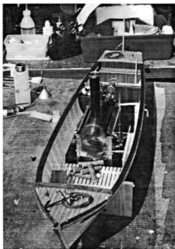
En haut : chaudière verticale du commerce (MAXWELL), ensemble moteur en V oscillant et chaudière verticale, Au centre : bicylindre horizontal à tiroirs plans, bicylindre vertical à tiroirs plans du type «pilon», En bas : installation à bord d'une chaloupe : chauffe à l'alcool à brûleur à mèche et l'outillage du modéliste, ensemble d'une installation à bord d'un modèle à roue, chauffe au gaz.
