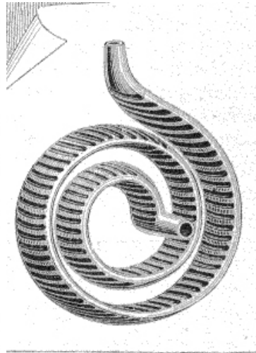
Fig. 1. — Chaudière à vaporisation instantanée de MM. Serpollet. 1. Vue d'ensemble de la chaudière (dispositif expérimental). — 2. Coupe transversale de la chaudière, en grandeur naturelle. Le trait AB indique, à une échelle un peu exagérée, la coupe transversale de la capacité intérieure de la chaudière.
